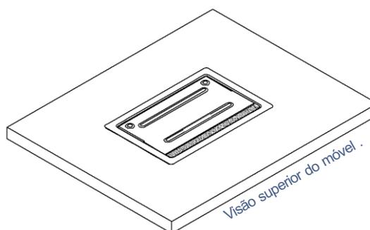
③ Com a caixa na furação, acesse a parte inferior do móvel e parafuse as alças, no móvel e na caixa.
