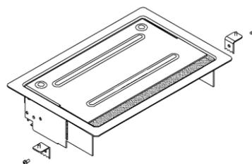
② Posicione a caixa de mesa na área cortada e encaixe-a;
