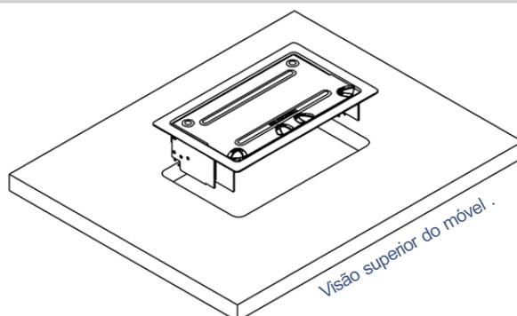
**3** Com a caixa na furação, acesse a parte inferior do móvel, recoloca as alças de fixação, parafusando-as na caixa e na mesa.
