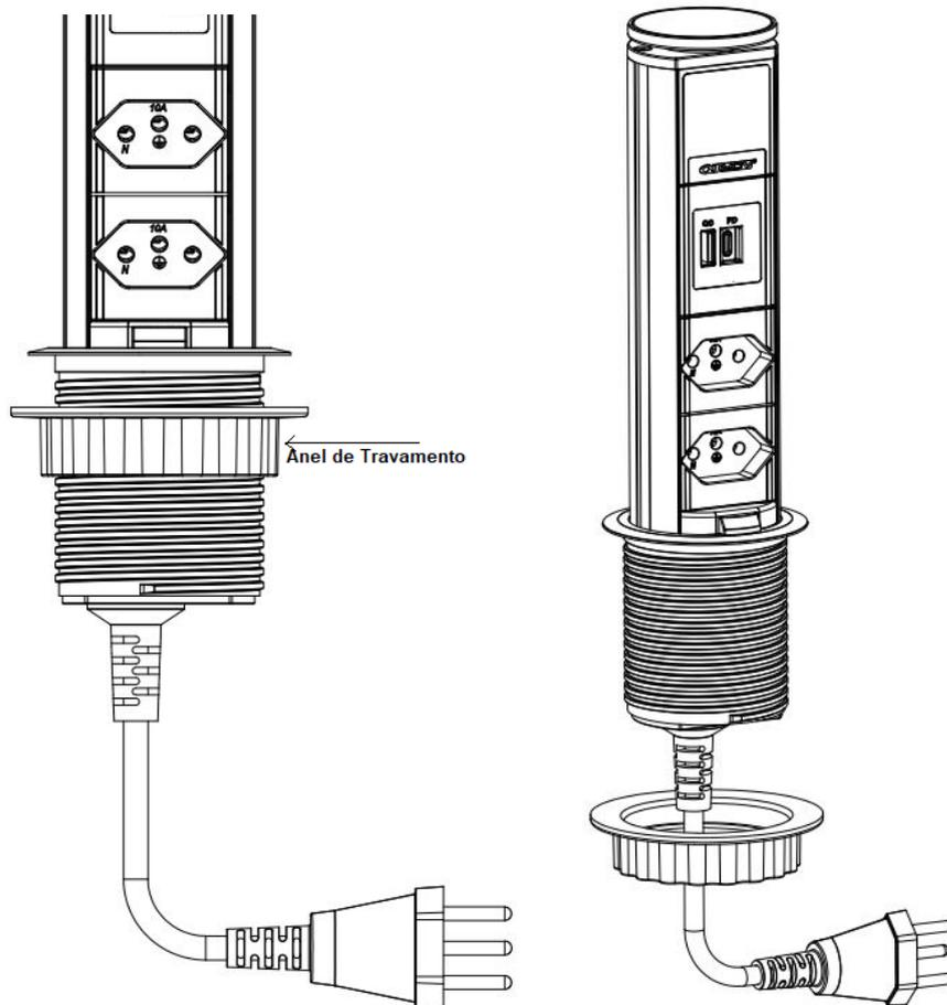
3. Passe o cabo pela furação e coloque o mini totem. Certifique-se que o mesmo está bem encaixado. Além disso, embaixo do móvel passe o anel de travamento pelo cabo de alimentação.
