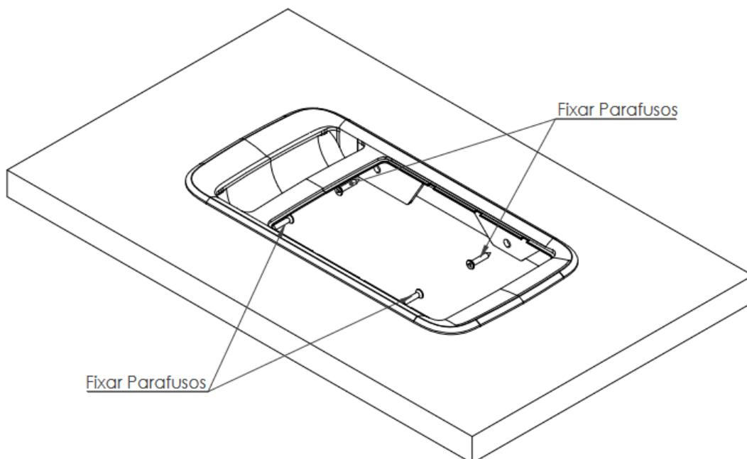
3. Depois de feita a fixação do colar, deve-se encaixar o dispositivo elétrico ao colar. Encaixar primeiro uma das laterais que contenham as travas de fixação, pressionando a lateral oposta até ouvir o “click” de encaixe de cada trava;
