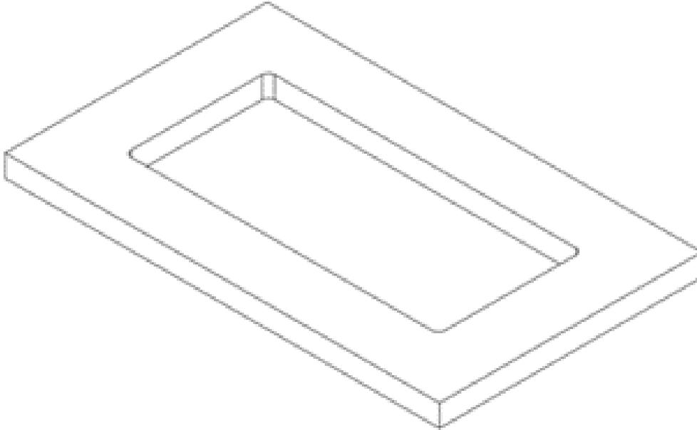
2. Encaixar o colar no recorte do tampo, pressionando contra o tampo e fazendo a fixação através dos parafusos que acompanham o produto;
