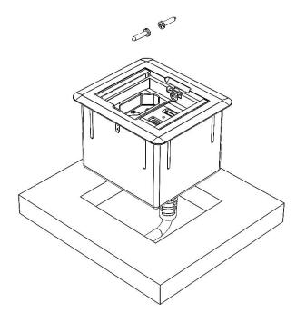
3. Proceda à fixação através de parafuso por dentro da caixa, utilizando uma chave de fenda cruzada ou parafusadeira.
