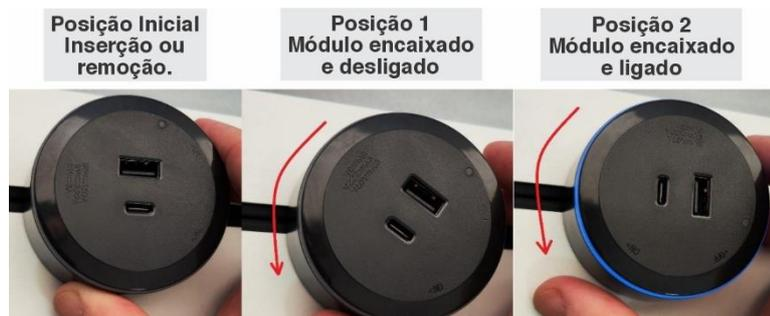
3) Para liga ou removê-lo, basta girá-lo no sentido anti-horário, sendo a posição 1 desligado, porém ainda encaixado ao trilho de energia, e a posição inicial pronto para remoção.
